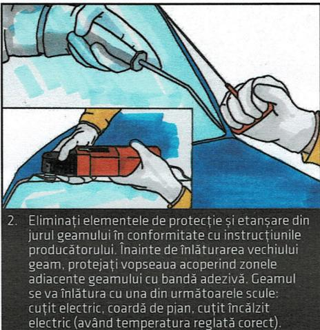
2. Eliminați elementele de protecție și etanșare din jurul geamului în conformitate cu instrucțiunile producătorului. Înainte de înlăturarea vechiului geam, protejați vopseaua acoperind zonele adiacente geamului cu bandă adezivă. Geamul se va înălța cu una din următoarele scule: cuțit electric, coardă de pian, cuțit încălzit electric (având temperatură reglată corect).
