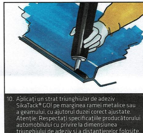
10. Aplicații un strat triunghiular de adeziv SikaTack® GO! pe marginea ramei metalice sau a geamului, cu ajutorul duzei corect ajustate. Atenție: Respectați specificațiile producătorului automobilului cu privire la dimensiunea triunghiului de adeziv și a distanțierelor folosite.
