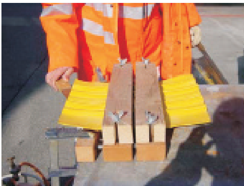
1. Sudarea cap la cap, folosind dispozitivele de prindere și lama de cupru
